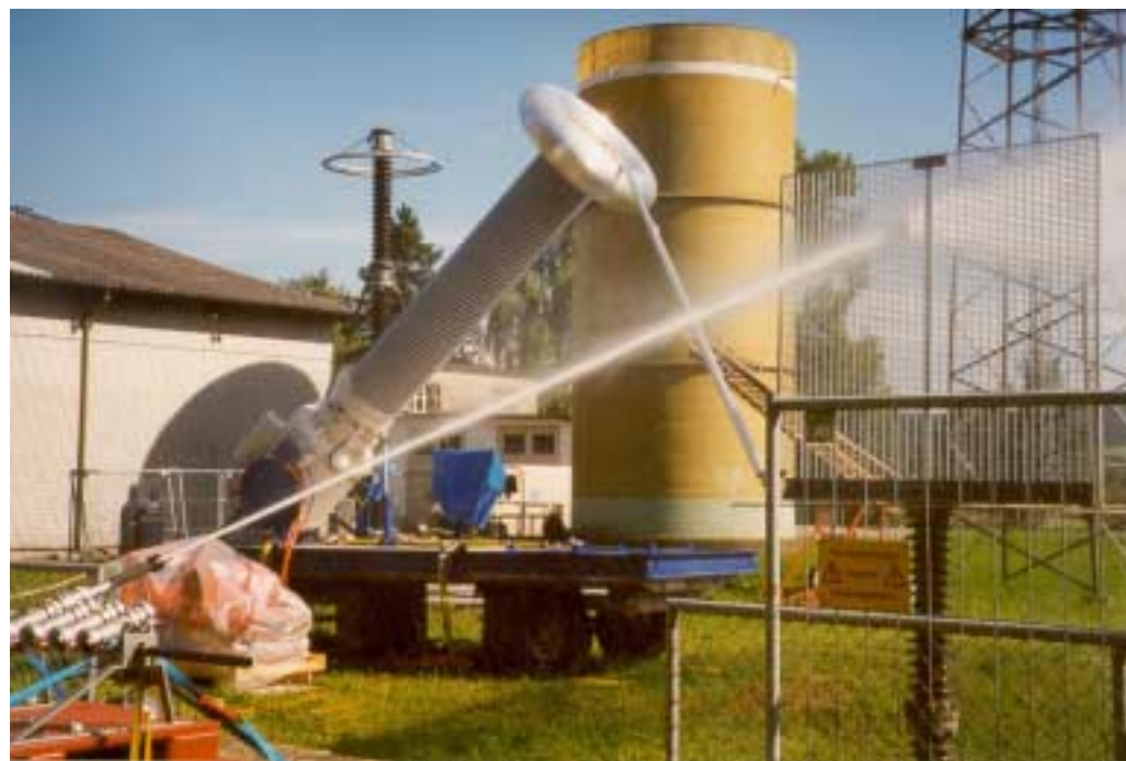
Bild 1 Versuchsaufbau in der FKH-Versuchsstation in Däniken: Im Vordergrund links: isolierte Konsole mit diversen Strahlrohren, rechts: Prallgitter unter Hochspannung, im Hintergrund: Mobiler Prüftransformator 510 kV.
