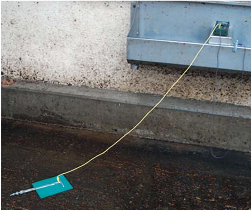
Bild 2 Einfache Möglichkeit zur Kontaktierung eines Betonbodens mittels eines nassen Schwammappens unter einer Metallelektrode zur Messung einer Wechselspannungsdifferenz zwischen dem Betonboden und einer metallischen Tränke.
