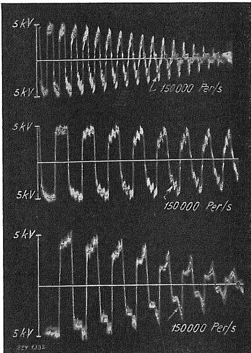
Fig. 25. Entladeschwingung beim Kurzschluss einer 500 m-Freileitung.
