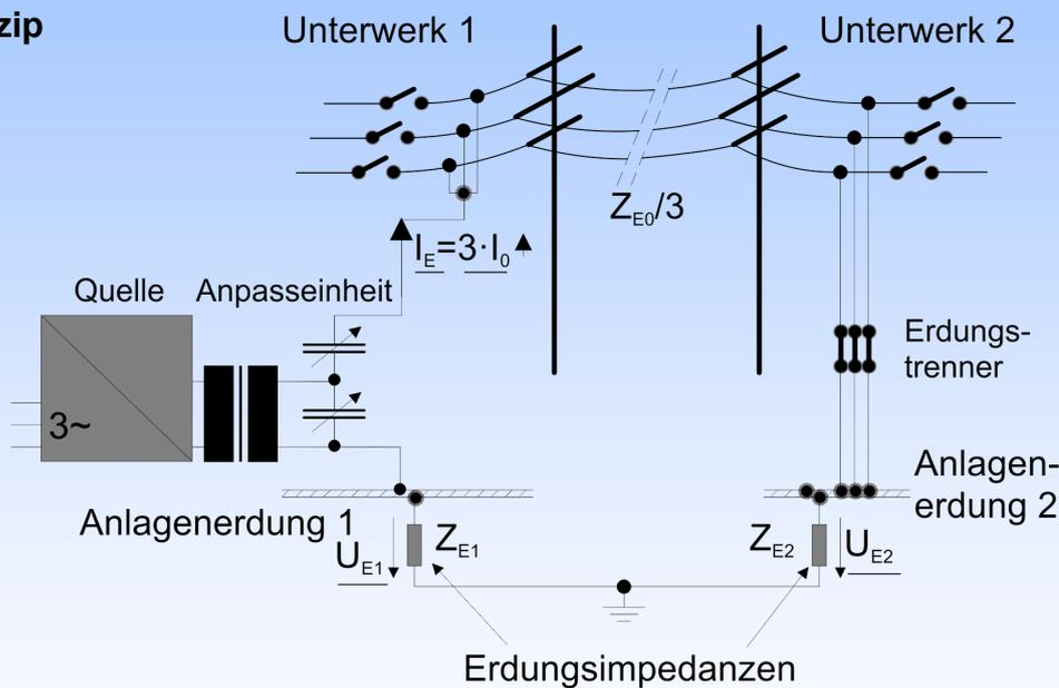
Messungen nach der Strom-Spannungs-Methode
