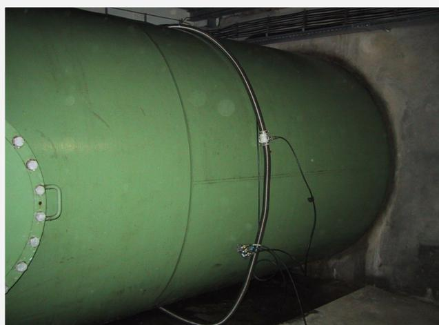
**Rogowskispule zum Messen von Strömen in Druckrohren oder Freileitungsmasten**
