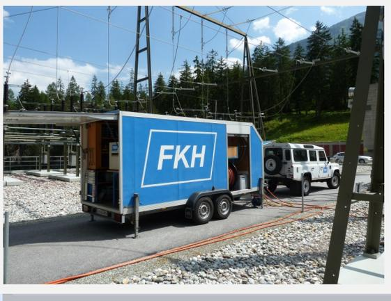
Mobile Speisequelle für die Erzeugung des experimentellen Erdschlussstromes
