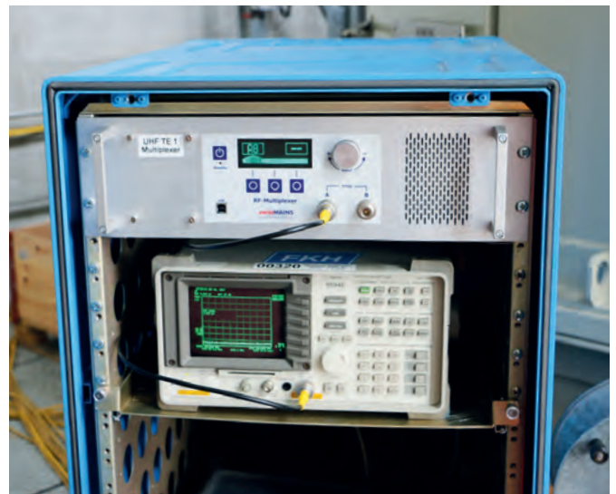
Abbildung 3: Multiplexer und Spektrum Analysator
