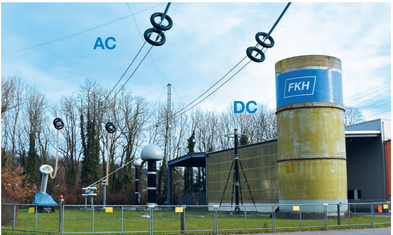
Abbildung 1: Übersichtsfotografie der Modell-Hybridfreileitung in der Versuchsstation der FKH in Däniken
