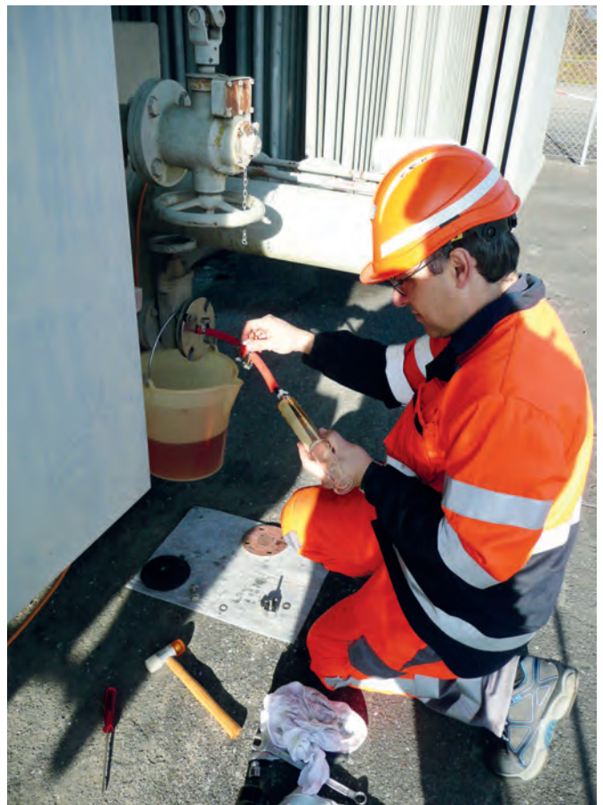
Abbildung 1: Probeentnahme für eine Zersetzungsgasanalyse mittels Glasspritze am Hauptschieber eines Leistungstransformators
