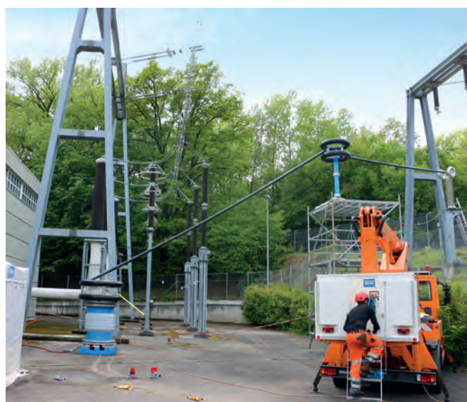
Abbildung 2: Kabelprüfung im UW Verbois mit TE-Messung
