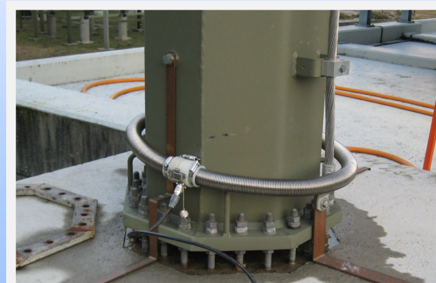
Rogowski-Spule zur Messung von Erdungsströmen in Masten
