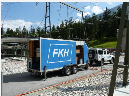
Mobile Speisequelle für die Erzeugung des experimentellen Erdschlussstromes
