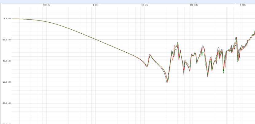
FRA-Messungen an einem 3-Phasen-Transformator
